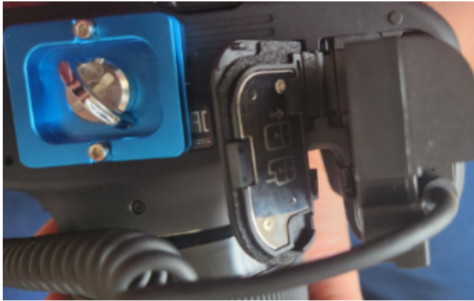
Imagem 16 - Encaixe do adaptador da bateria.
