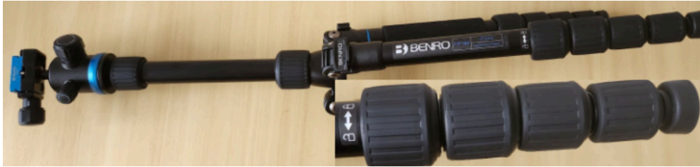
Imagem 4 - Tripé com as pernas estendidas; zoom nos quatro pontos de rosqueamento para extensão.
