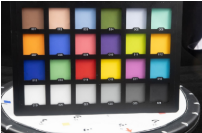
Imagem 21 - Fotografia do ColorChecker com o artefato atrás para posterior ajuste do balanço de branco.
