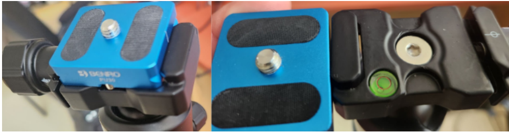
Imagem 13 - Suporte fixador para encaixe na câmera; suporte desacoplado do tripé.
