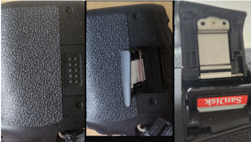
Imagem 12 - Processo de abertura do compartimento do cartão SD.
